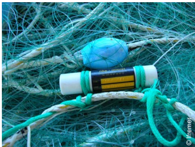
Capteur pression-température monté sur un filet
