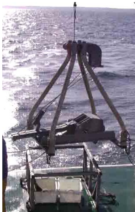
Photo 4 : La benne Hamon (poids à vide 200 kg)
