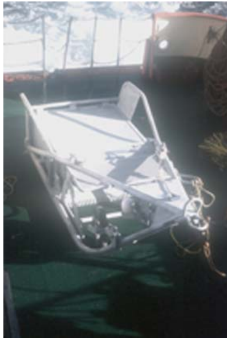
Photo 5 : Le traîneau drague AQUAREVE (poids à vide 250 kg)
