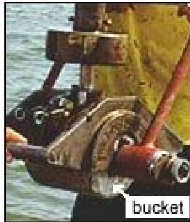
Photo 1 : La benne Shypeck (poids à vide 45 kg)
