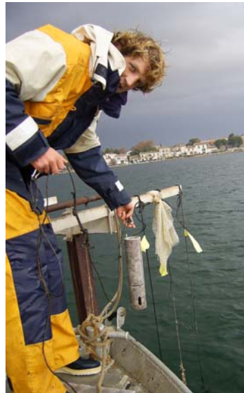
Figure 2 : Récupération des données acquises par la sonde TS et prélèvements de coquillages lors d'une campagne OMEGA Thau.
