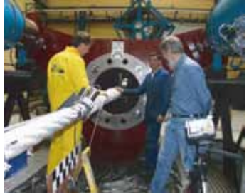
Essais échelle 1 sur câble 500 tonnes (machine LCPC Nantes, Instrumentation et programmes de tests Ifremer)
