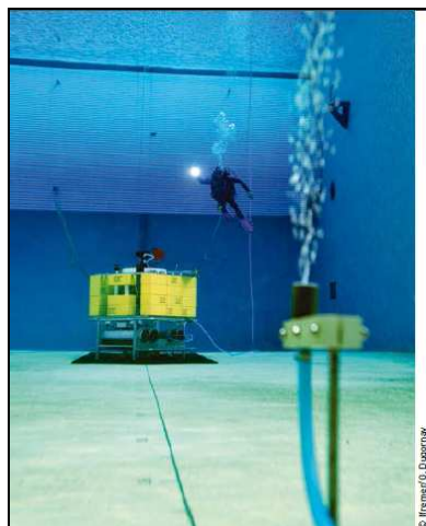
Fig. 3 : Modèle acoustique BOB déployé au bassin d'essais du centre Bretagne pour des tests de fonctionnement sur cible artificielle
