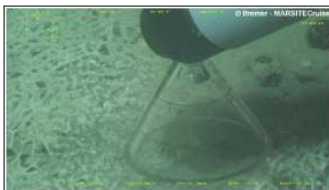
Fig. 1 : Mesure Raman sur des sorties de gaz au-dessus de filaments bactériens
