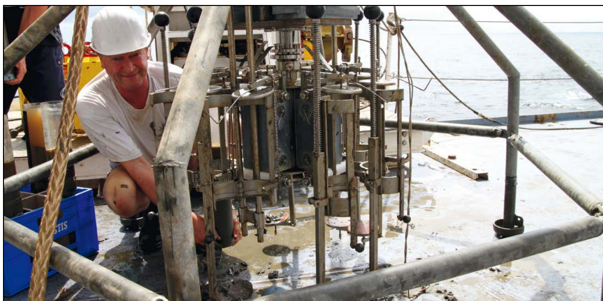
Remontée du carottier multitubes, récupération des échantillons de sédiment à bord du Pourquoi pas ? (©Ifremer - G. Bourret/Campagne WACS)
