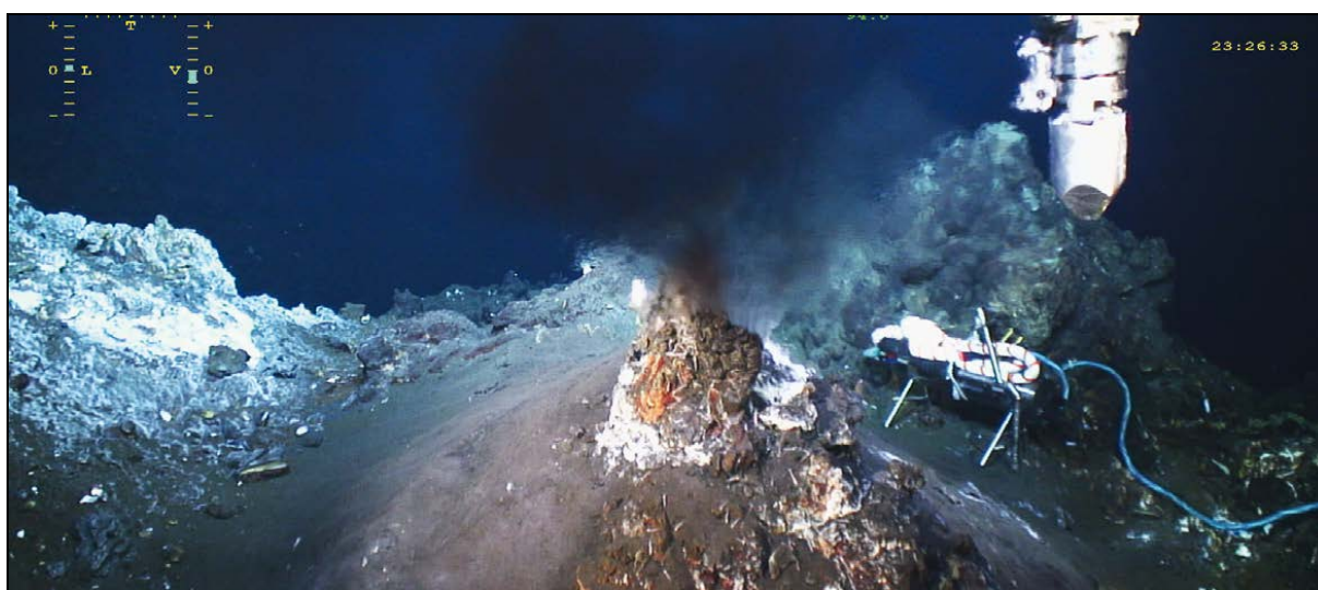
Observatoire EMSO-Açores : installation par le ROV Victor 6000 d'un capteur de chlorinité dans un fumeur actif à 1700 mètres de profondeur (© Ifremer - Victor 6000/Campagne MoMarsat)
