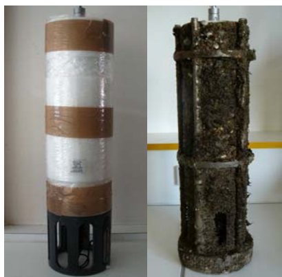
Figure 1 : (a) sonde multiparamètre avant déploiement, (b) sonde multiparamètre au retour de campagne
