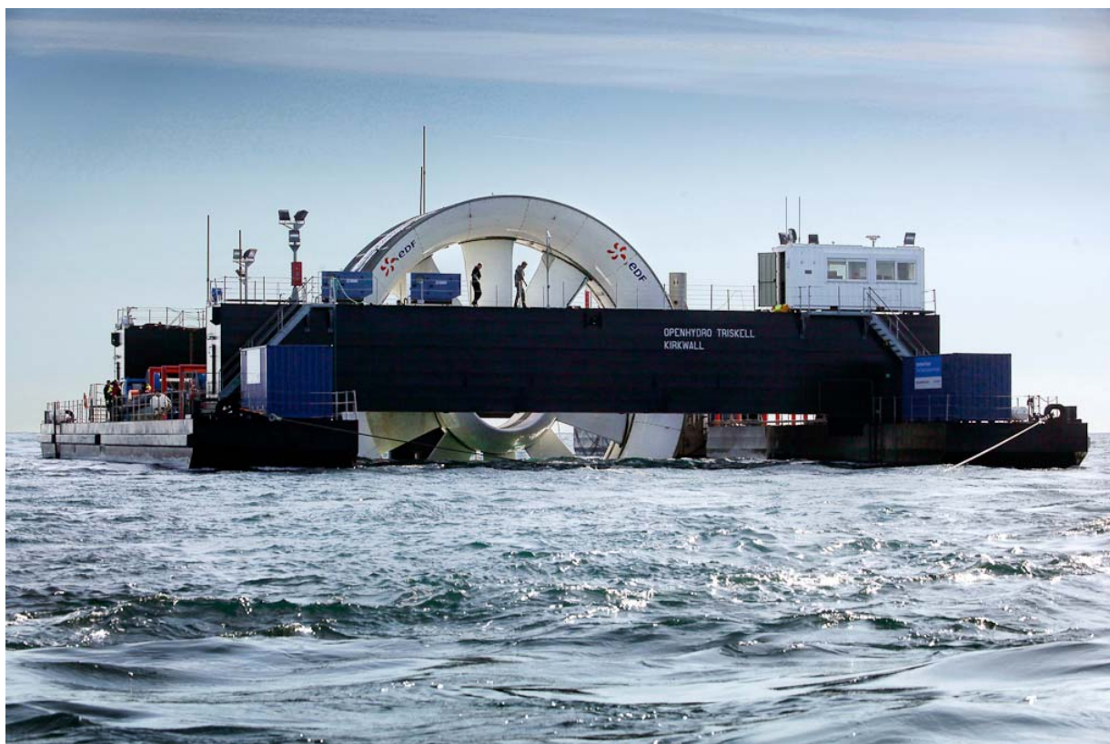
Hydrolienne OpenHydro / DCNS pour EDF au large de Bréhat ©EDF Rémi Artiges
