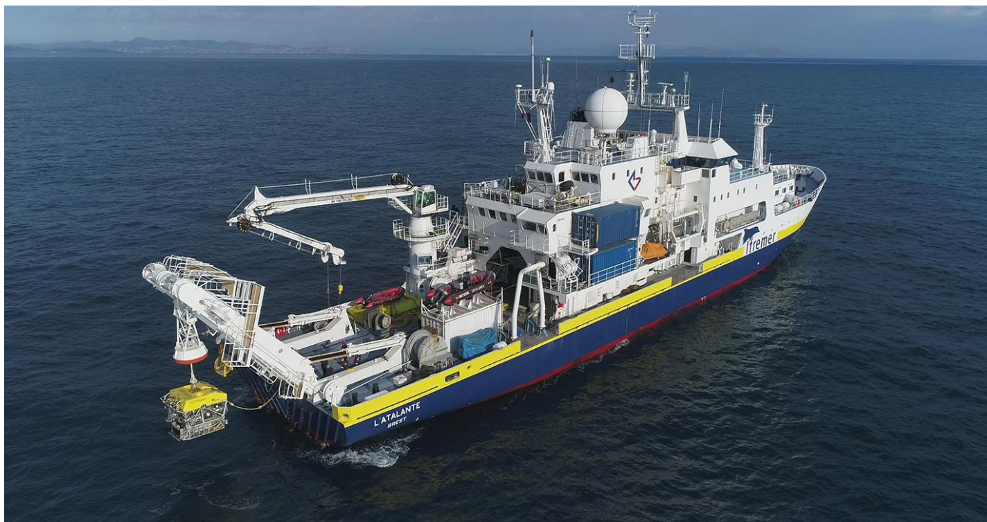
L'Atalante est un navire hauturier de 84,60 mètres de long. Il est doté de sondeurs et d'équipements acoustiques ainsi que d'un treuil grands fonds. © Ifremer - Stéphane LESBATS
