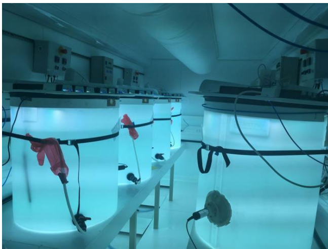
Containers-laboratoires embarqués pour conduire des expériences de mélange entre l'eau du fond (pompage à 500 mètres) et l'eau de surface pour étudier les effets fertilisants ou toxiques des fluides hydrothermaux.
