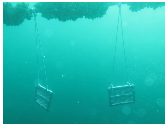
Echantillonneurs passifs des contaminants dans l'eau, déployés dans le golfe de Gascogne. © AZTI - Ekaitz Erasquin
