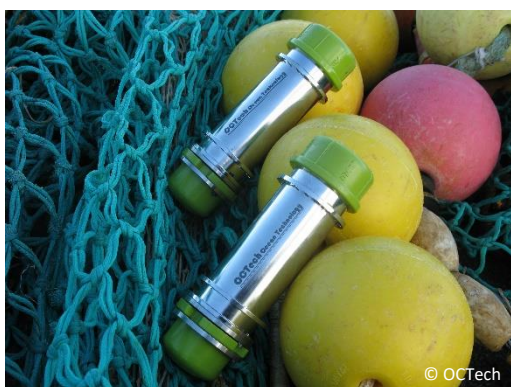
Prototypes de capteurs acoustiques développés et testés par la société OCTech dans le cadre du projet LICADO
