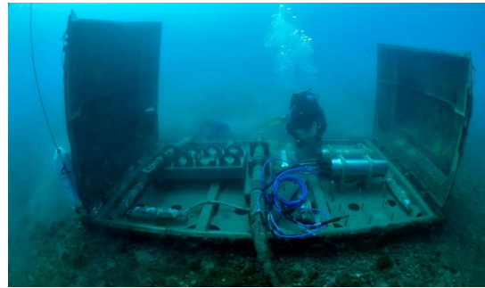
Exemple d'instrument de mesure déposé sur le fond de la pente sous-marine niçoise (piézomètre à gauche) et raccordé à la station EMSO (à droite), pour suivre en temps réel la déformation des sédiments. ©Ifremer - Olivier Dugornay
