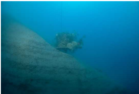
Exemple d'instrument de mesure déposé sur le fond de la pente sous-marine niçoise (piézomètre à gauche) et raccordé à la station EMSO (à droite), pour suivre en temps réel la déformation des sédiments. ©Ifremer - Olivier Dugornay
