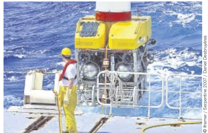
Depuis le portique du Pourquoi pas ?, mise à l'eau du Victor 6000 pour une plongée sur le site hydrothermal Ashadze.
