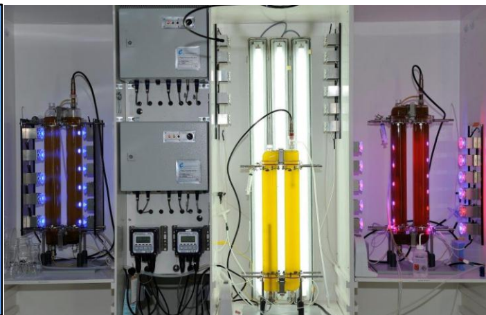
Photobioréacteurs pour l'étude de la physiologie des algues au Centre Ifremer Atlantique ©Ifremer / Michel Guillou
